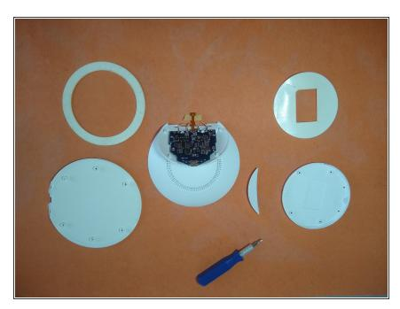
No modelo EP-NG930 Samsung wireless chager (Vietnam), os parafusos da placa de circuitos ficam embaixo. É necessário retirar o adesivo emborrachado para acessar.
