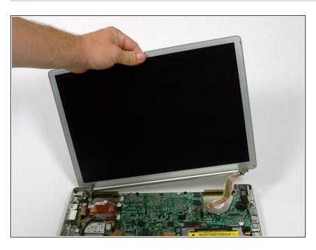
Levanta el ensamblaje de la pantalla de la caja inferior.
