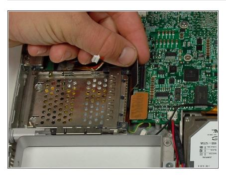
Desconecta el cable de la tarjeta de PC de la placa lógica.
