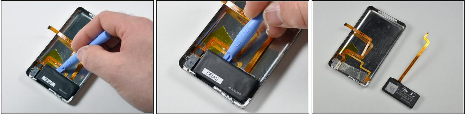
**⚠** Stai attento a non danneggiare i cavi della presa audio o della batteria durante questo passo.
